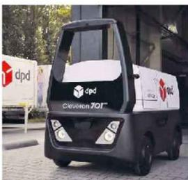
**Das autonome Fahrzeug Cleveron 701** aus Estland ist das erste autonome Lieferfahrzeug in Europa mit einer Zulassung für den Straßenverkehr – vorausgesetzt, ein sogenannter Teleoperator überwacht die Fahrt über eine Kamera. Foto: Cleveron
